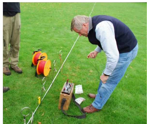
Utilización de métodos eléctricos en el campo – en este caso, se intenta localizar un tambor de acero enterrado (Fotos de Peter Kennett)
