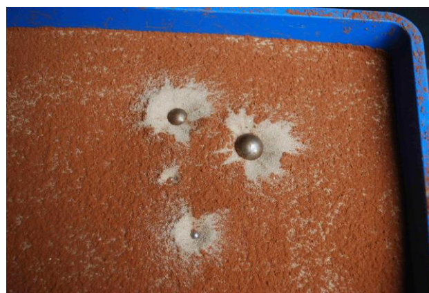
Cráteres producidos al dejar caer 4 bolas de acero de diferentes tamaños en una bandeja de arena (con cacao espolvoreado) (Foto: Peter Kennett)
