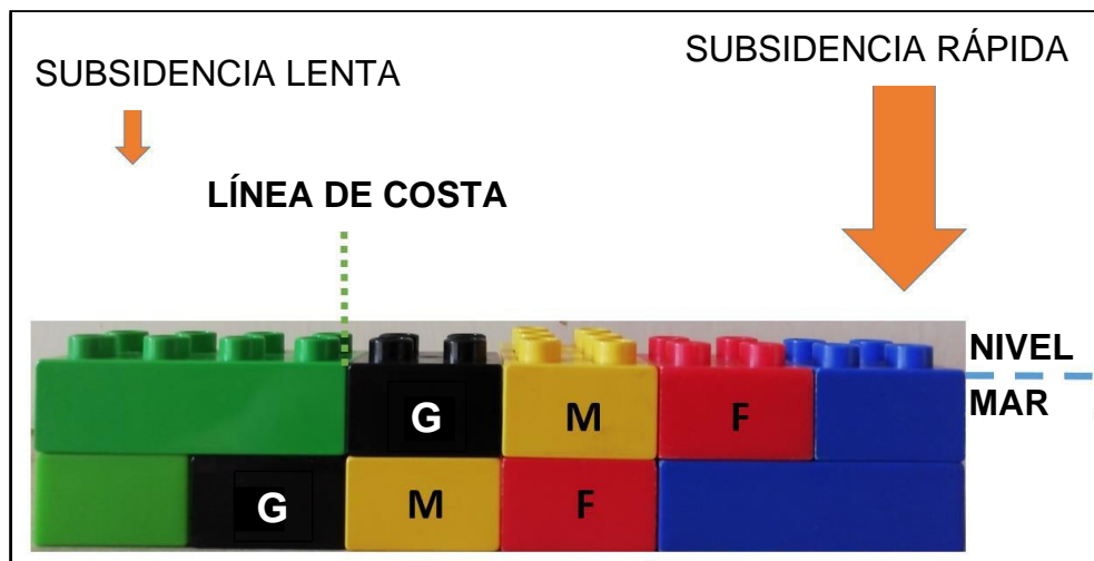
Figura 2. Un descenso relativo del nivel del mar provoca un desplazamiento de la línea de costa hacia el mar. Como consecuencia, se produce un desplazamiento lateral de los ambientes deposicionales, de manera que la posición de los diferentes sedimentos también se ha desplazado hacia el mar.
