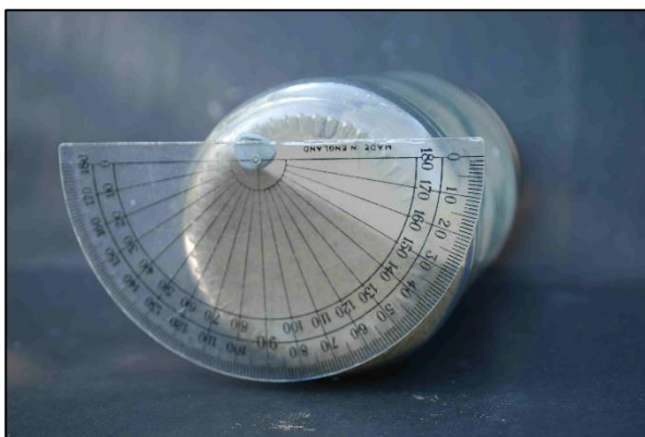
Comprobando el ángulo de reposo de arena seca, como en una duna del desierto
