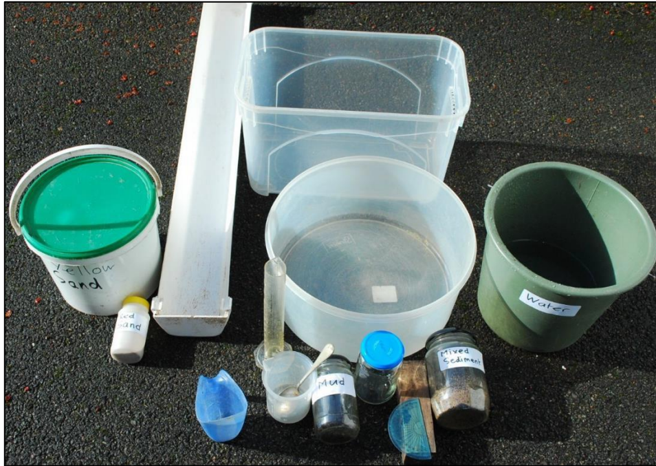
Los aparatos y materiales: canaleta con tope final; caja cuadrada de plástico; caja redonda de plástico; probeta; espátula; vaso de precipitados, cucharilla; bloque de madera; transportador; bote con tapadora; arena amarilla lavada; arena roja lavada; fango en un bote con tapadora; sedimento mezclado en un bote con tapadora; cubo con agua.
