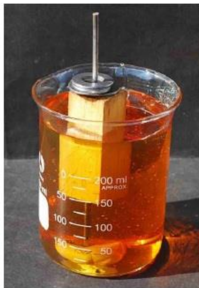
Bloque de madera en jarabe, con el peso de arandelas de acero. (Foto: Peter Kennett)
