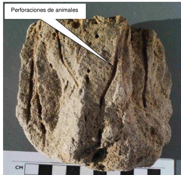
Foto 5: Vista lateral de una caliza dura atravesada por tubos. Caliza de Lincolnshire, Jurásico, Ketton, Inglaterra
