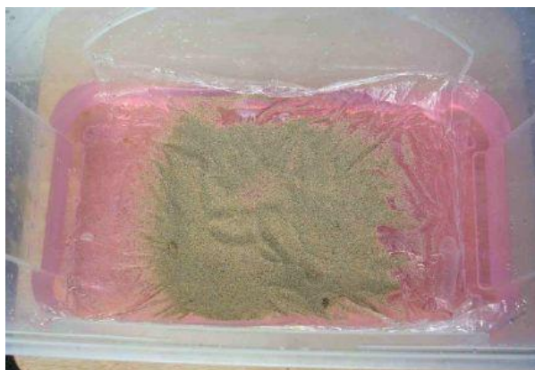
Foto 6: La capa de sorra escampada al plàstic sobre l'aigua (vista zenital)
